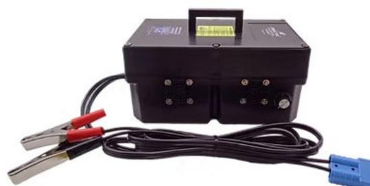
Régulation à tension constante. Permet de réguler le débit des pompes de 12 volts. Comprend une protection contre les changements de polarité et une protection thermique. Système d'arrêt de la pompe. Peut être réglé sous un débit allant jusqu'à 40 ml/min. Pour la pompe MEGA-MONSOON.
