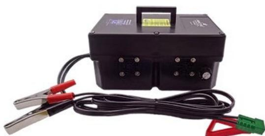
Régulation à tension constante. Permet de réguler le débit des pompes de 12 volts. Comprend une protection contre les changements de polarité et une protection thermique. Système d'arrêt de la pompe. Peut être réglé sous un débit allant jusqu'à 40 ml/min. Pour les pompes MONSOON et HURRICANE.
