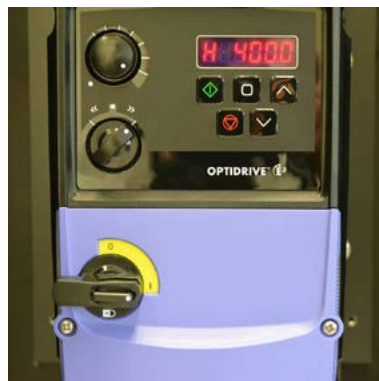
Fig. 8e Switch 3 set to the max 400 Hz
